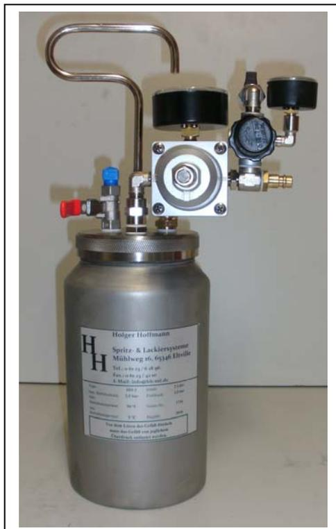
Das Druckgefäß hat einen leicht abnehmbaren Deckel, auf dem alle Armaturen, wie z.B. Druckminderer, Sicherheitsventil, Absperrventile etc. untergebracht sind.
